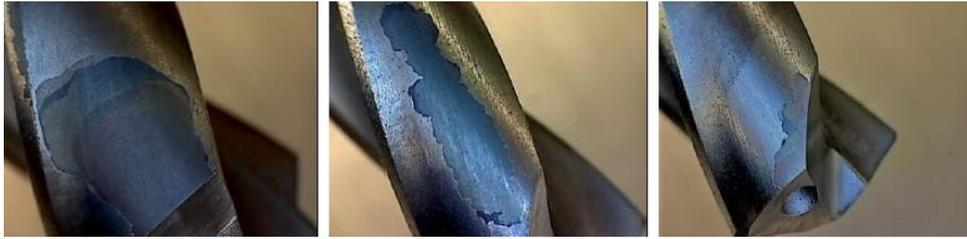
Schichtabplatzungen im Bohrversuch nach mehrmaligem Beschichten ohne Entschichtung
