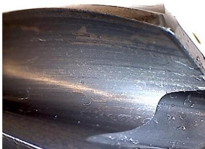
Abplatzung der Beschichtung im Spanraum
