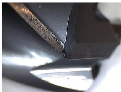
Zerstörte Rundschliffase durch Schichtabplatzung
