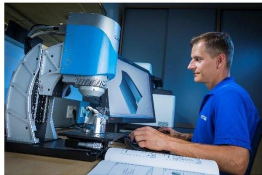
Kontrolle der Schneidenverrundung mit 3D Meßmikroskop
